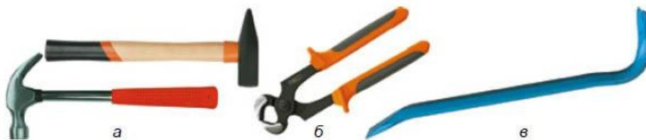
Рис. 5. Основные инструменты для соединения деталей с помощью гвоздей: а – молотки; б – клещи; в – инструмент для вытягивания гвоздей (выдерга)
