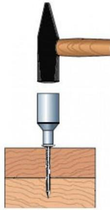
*Рис. 12. Углубление шляпки гвоздя с помощью цилиндрического устройства*
